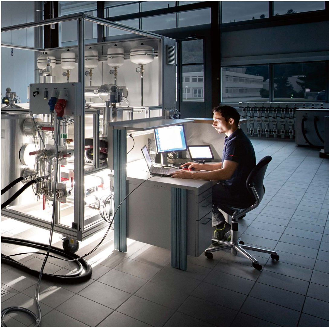
Prüfstand für Wärmepumpen mit Klimakammer
